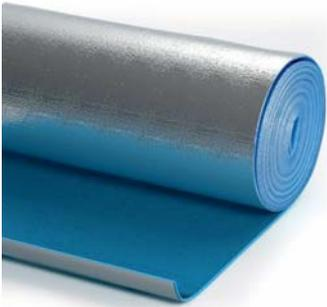
Пенофол 2000 - теплоизоляционный материал на основе вспененного полиэтилена. Пенофол выпускается в виде рулонов и матов шириной 0,6 и 0,9 м. Материал выпускается в различных исполнениях: фольгированный (тип А), фольгированный самоклеющийся (тип С). Материал используется для изоляции вентиляционного оборудования и воздуховодов.
