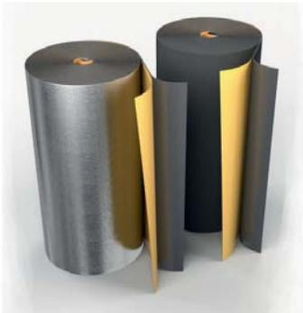
Изготавливается из вспененного полиэтилена, имеет закрытую ячеистую структуру. Надежно защищает от конденсата и тепловых потерь, является эффективным шумопоглощающим и вибродемпфирующим материалом, самоклеющийся. Прост при установке, безвреден для здоровья и окружающей среды. Цвет черный.
