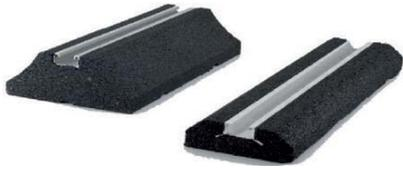
Общее описание: Идеально подходят для всего вибрационного оборудования. Рециркулированные резиновые блоки. Алюминиевые рельсы (40×20 мм) с закрытыми трапециевидными ножками подходят для крепления М10. Рекомендуемая температура эксплуатации от -30°C / +80°C
