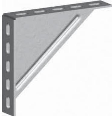
Многофункциональный подвесной и крепежный элемент. Используется для крепления инженерного оборудования к несущим конструкциям здания. Также, в комбинации с U, L, С профилями может использоваться в качестве самонесущей конструкции. Используется, как одинарный элемент, так и комбинацией соединенных между собой А-образных кронштейнов. Гальванопокрытие толщиной 8–10 микрон для защиты от коррозии.
